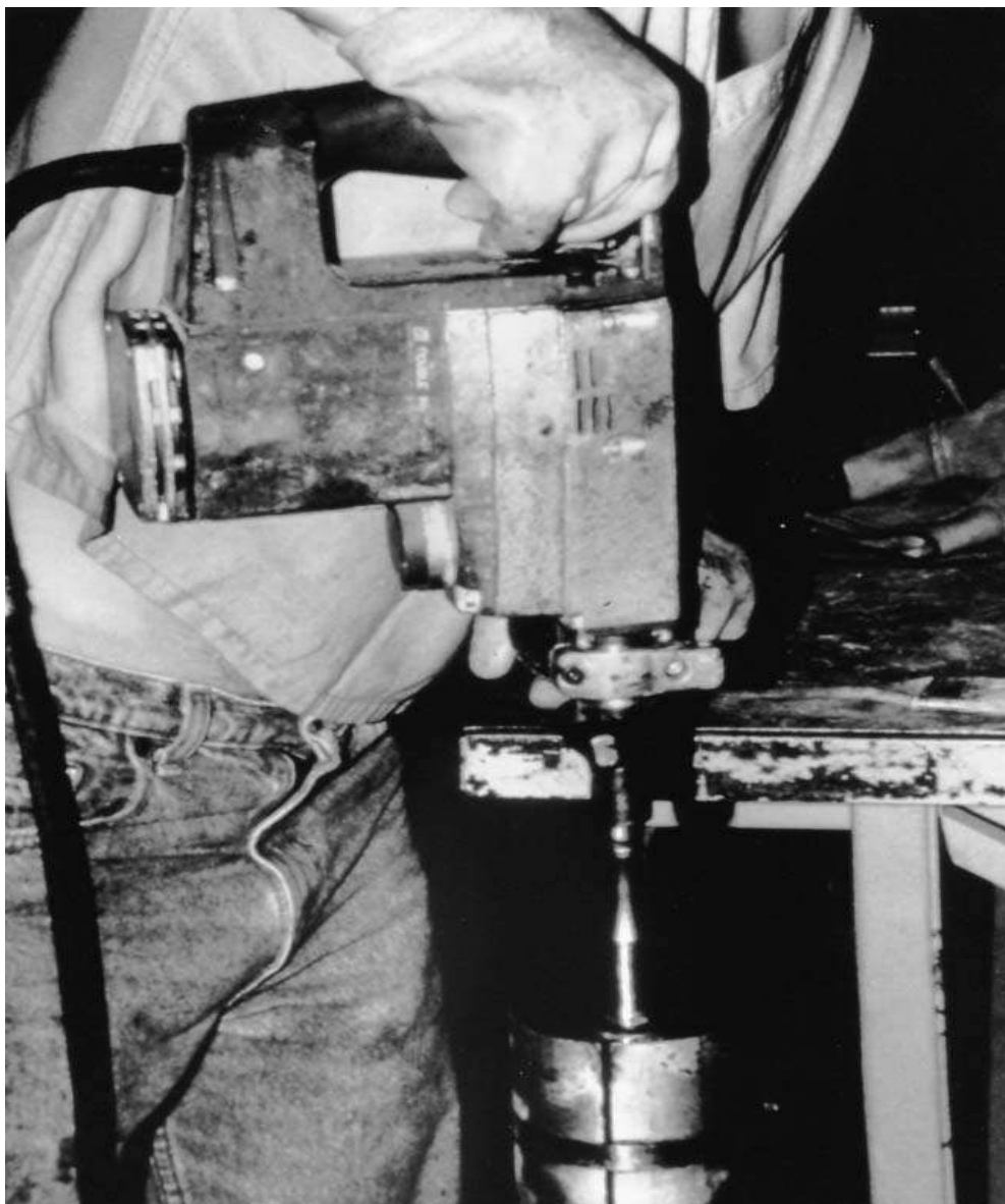
شکل ۱- چکش لرزان برای قالب‌گیری آزمون‌های بتن غلتکی
