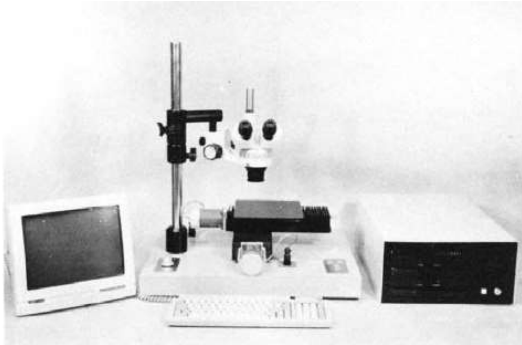
شکل ۳- عکسی از دستگاه پیمایش خطی / شمارش نقاط رایانه‌ای که الزامات این روش آزمون را تامین می‌کند
