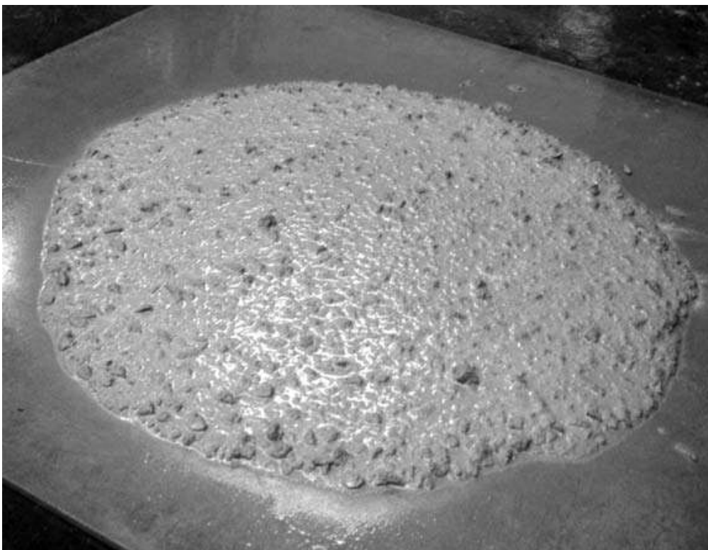
شکل الف-۲- بتن با کمی آب انداختگی به صورت درخشندگی در سطح (VSI=1)
