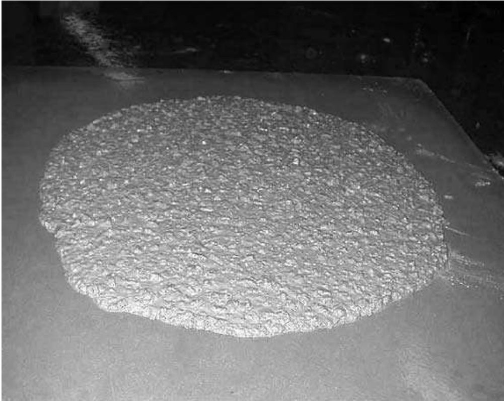
شکل الف-۱- بتن همگن و بدون آب انداختگی (VSI=0)
