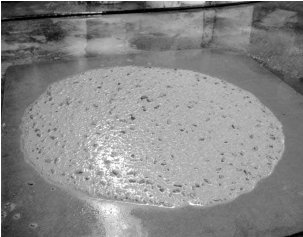
شکل الف-۳- بتن با هاله ملات و درخشندگی آب در سطح (VSI=2)
