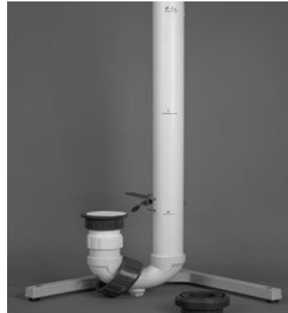
شکل ۱- دستگاه J-Tube جهت اندازه‌گیری مقاومت به نفوذ آب غشا
